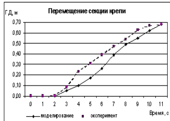
Рисунок 3 – Перемещение секций крепи
