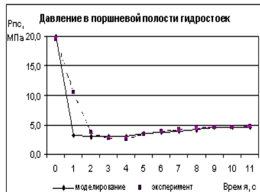
Рисунок 4 – Давление в поршневой полости гидростоек
