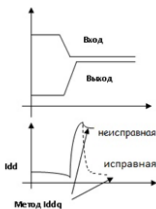
Рисунок –14. Ток в исправной и неисправной схемах.
