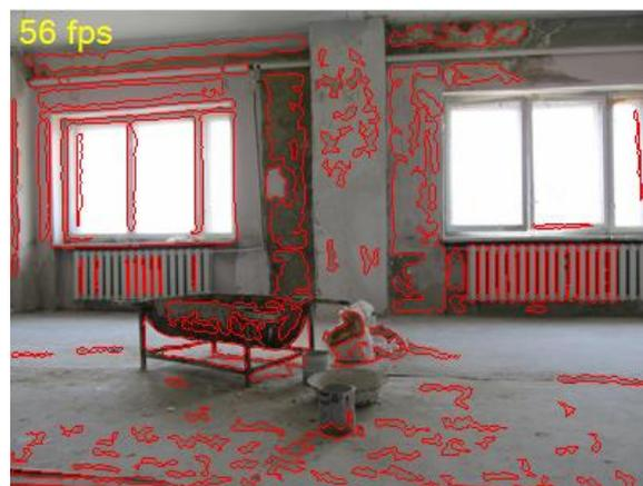
Рисунок 8 – Результат выделения примитивов на оригинальном фотоснимке
