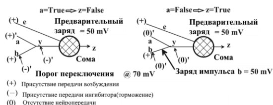
Рисунок 7. – Функционирование дендритного элемента НЕ.
