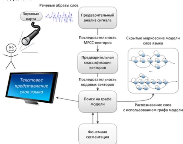
Рисунок 2 – Функциональная схема системы распознавания речи
