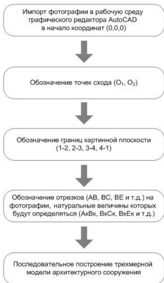
Рисунок 1 – Структура алгоритма построения трехмерной модели архитектурного сооружения методом перспективных масштабов
