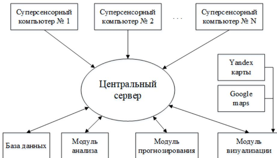
Рисунок 3 – Архитектура интегрированной клиент-серверной суперсенсорной системы [3]
