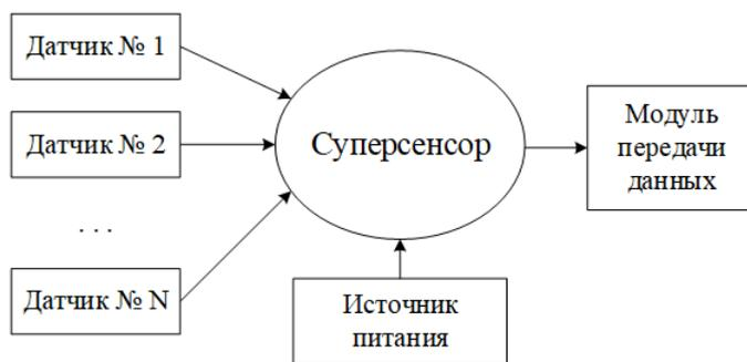
Рисунок 2 – Архитектура суперсенсора
