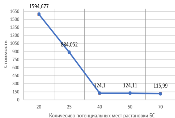
Рисунок 4 – Зависимость стоимости проектируемой сети от количества потенциальных мест расстановки базовых станций
