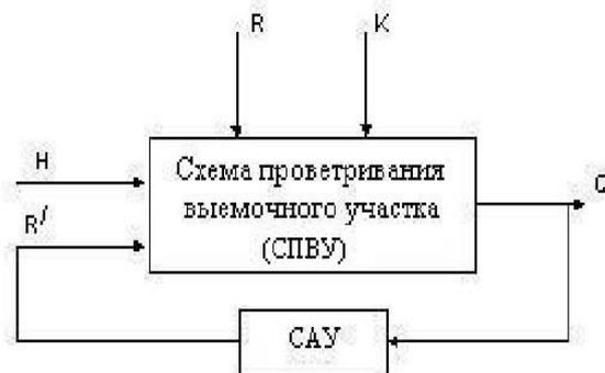
Рисунок 1 – Структурная схема автоматизированной СПВУ
