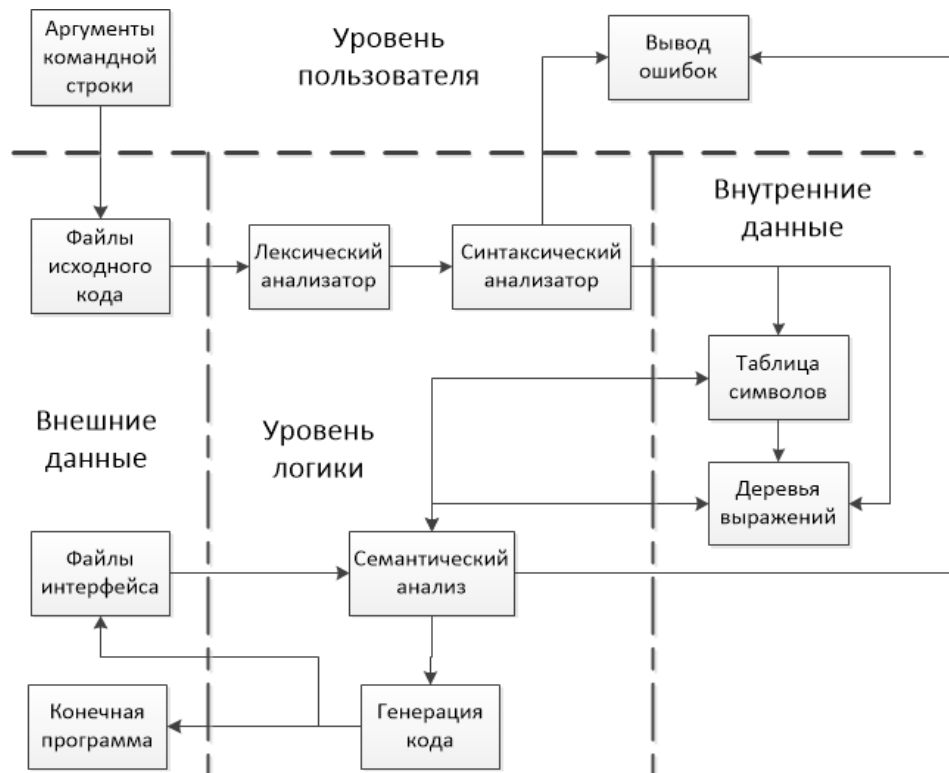
Рисунок 1 – Схема архитектуры компилятора
