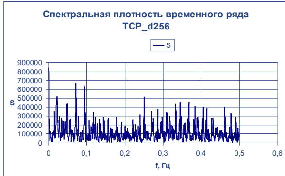
Рисунок 11 - Спектральная плотность сигнала TSP_d256
