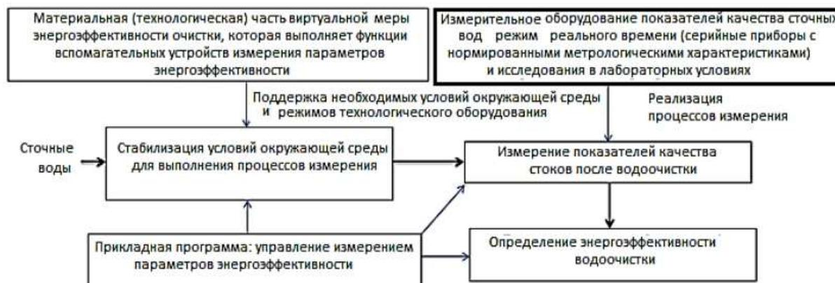
Рисунок 5 – Схема использования виртуальной физико-математической модели при поддержке управления очисткой сточных вод
