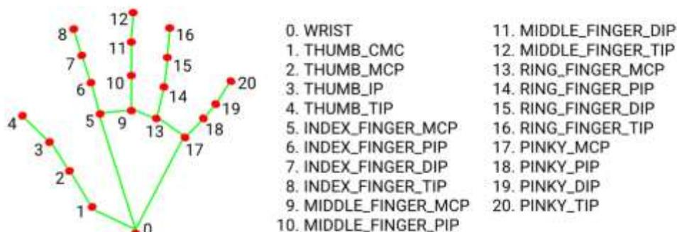
Рисунок 1 - Характерные точки, используемые для машинного обучения
